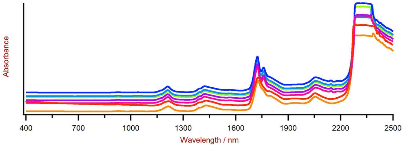
Figure 2. 使用 XDS RapidLiquid Analyzer 和 4 mm 一次性品瓶得得多元醇 Vis-NIR 光。出于示原因，用了光偏移。
