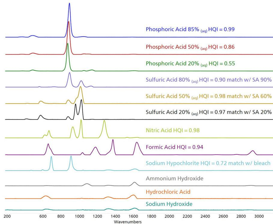
1中包含了各个酸的命中量指数(HQI)。拉曼光多子酸敏感,例如与酸的光相比,稀酸溶液的HQI受到大影,而硫酸(SA)稀液相于 $H_2SO_4$ 的光来保持高的HQI。
