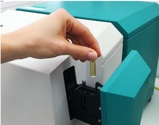
Figure 1. XDS RapidLiquid Analyzer 和 8 mm 一次性品瓶中的酸品。
