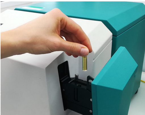
Figure 1. XDS RapidLiquid Analyzer 和一个 4 mm 一次性品瓶中的多元醇品。
