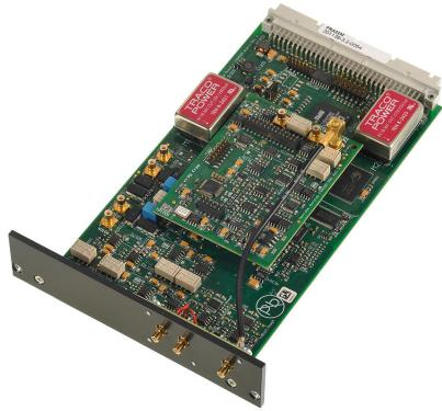
FRA32M 提供了用于量阻抗的工具,与 Autolab 用可量化学阻抗。模允在  $10 \mu\text{Hz}$  至  $32 \text{ MHz}$  的率范中同行恒位和恒流阻抗量(与 Autolab PGSTAT 用限  $1 \text{ MHz}$ )。除了的 EIS 化学阻抗之外,NOVA 件允用其它外部信号,如旋的速或光源率,以量-流体或光制阻抗。 FRA32M 模有功能大的匹配和真件,可分析阻抗数据。
