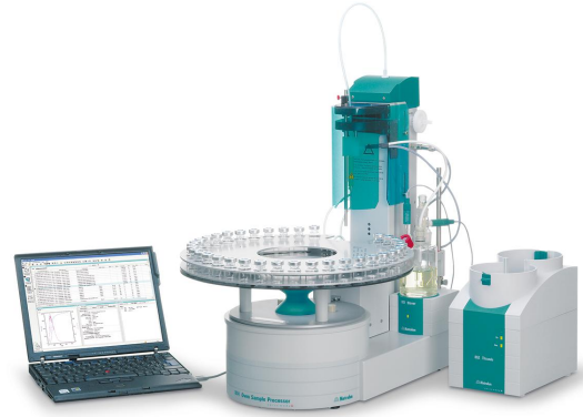
Figure 1. 全自系由 874 Oven Sample Processor 和 851 Titrand 成, 用于在样品中存在的任何水分蒸发后进行分析。
