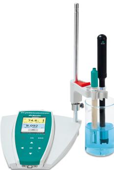
**Figure 1.** 914 pH/DO/Conductometer 配 O<sub>2</sub>-Lumitrode 和
