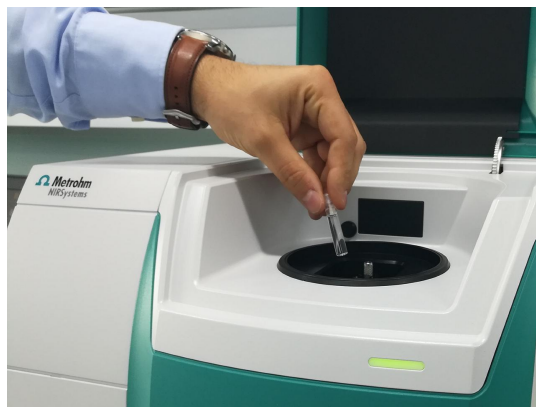
Hình 1. Máy phân tích chất lỏng DS2500 và mẫu được đựng trong vial dùng một lần.
