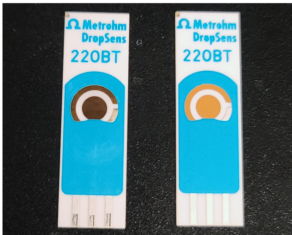
図2. 電気化学粗面処理前（左）と後（右）のWE表面
