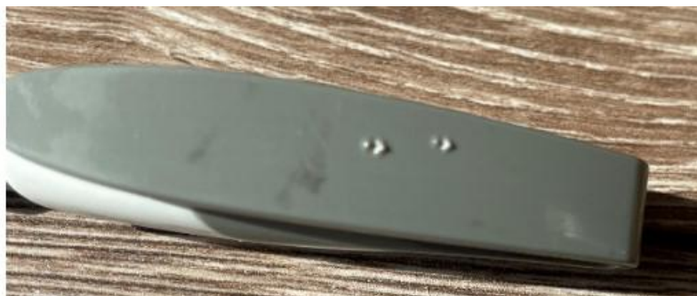
図3. 1064 nmレーザーと785 nmレーザー(MIRA XTR DS)で測定した灰色のプラスチックペン
