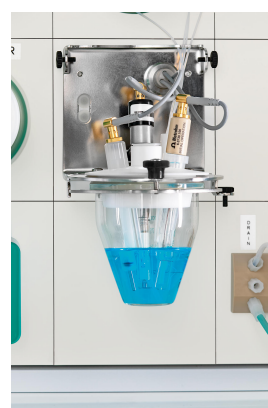
図3. 2060 CVS プロセスアナライザー内の電気化学セルのクローズアップ写真
