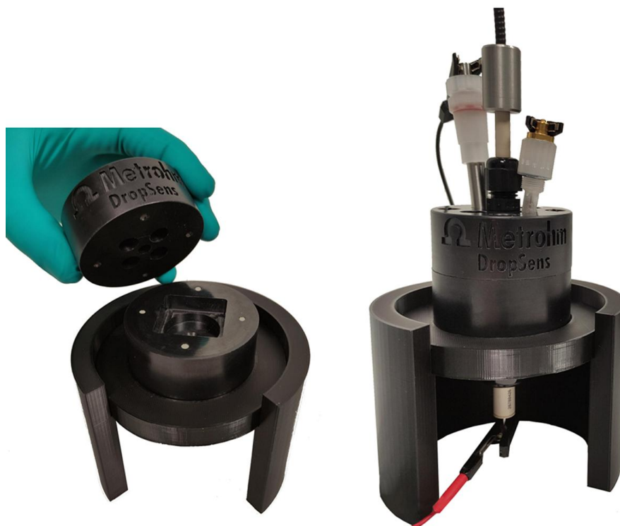
図 1. REFLECELL-C、従来電極用の UV-Vis セル。内部図 (左) と最適な位置決めのためにクランプで保持された WE、CE、RE、および光ファイバーを備え完全に組み立てられたセル (右)
