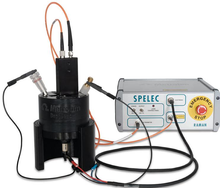
図1. SPELEC RAMAN 638装置とラマンプローブは、(a)スクリーン印刷電極用、(b)従来型電極用のラマン分光電気化学セルと組み合わせて用いられました。
