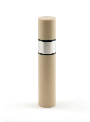
図1. 回転円筒電極(金属インサート、ハイトンOリング(黒)、PEEKホルダー)
