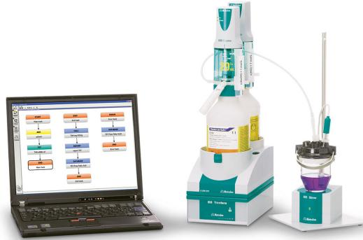
**Figure 1.** サーモプローブとティアモを装備した859Titrotherm。アルミニウム分析のセットアップ例。
