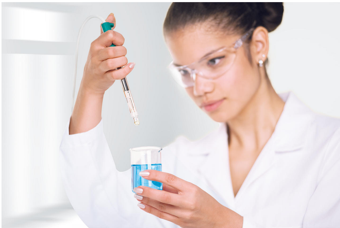
図2. Pt1000温度センサー付きユニット電極イージークリーン
