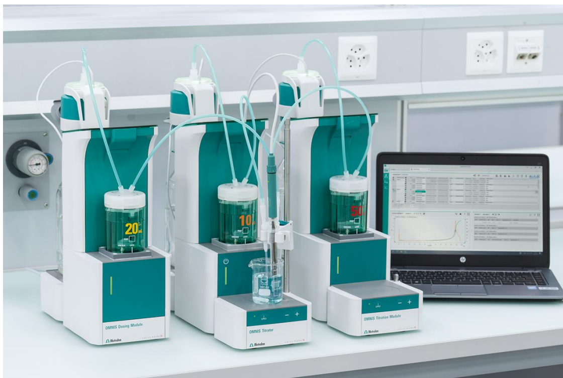
Figure 2. 水性サンプル中のカフェイン含有量を測定するための dPt Titrode 電極を備えた OMNIS 滴定装置。
