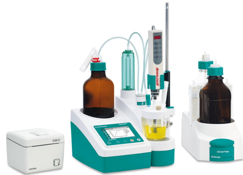
Figure 1. ポリトロン、溶媒ポンプ、および容量法カールフィッシャー指示電極を備えたEcoKF滴定装置
