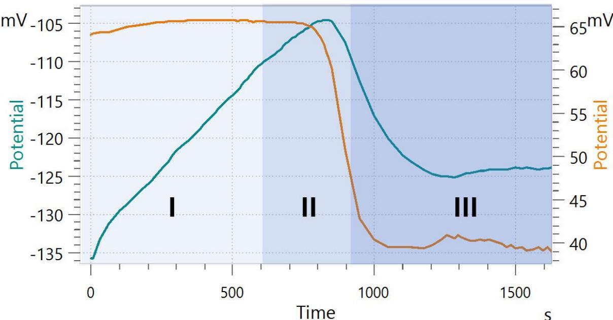
図2. 炭酸カルシウム生成の例示曲線です。緑色はカルシウムイオン選択性電極を用いて測定した遊離カルシウムイオンの電位を示し、オレンジ色はOptrodeで測定した電位を示しています。実験はpH11で実施されました。各色で示された段階は、前核生成相(I)、核生成(II)、および粒子成長(III)を表しています。
