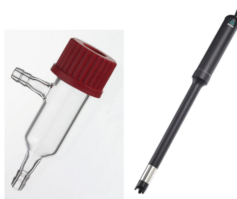
Figure 1. 使用済みフロースルーセル (左) とO 2 -ルミトロード (右)。
