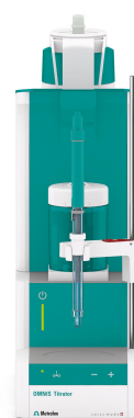
Figure 1. 水サンプル中のシアン化物を測定するためのシアン化物イオン選択性電極を備えたOMNIS基本滴定装置。
