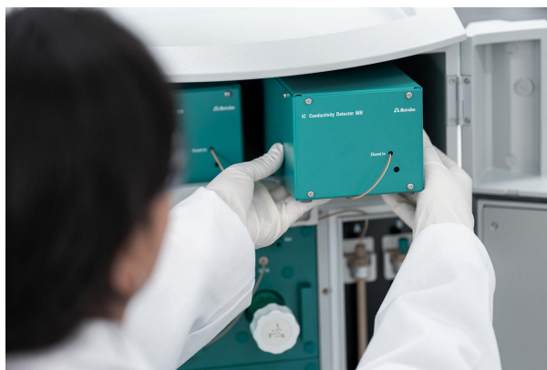
図 1. IC導電率検出器MBは、セル容量が小さく、メタン酸に対して不活性です。
