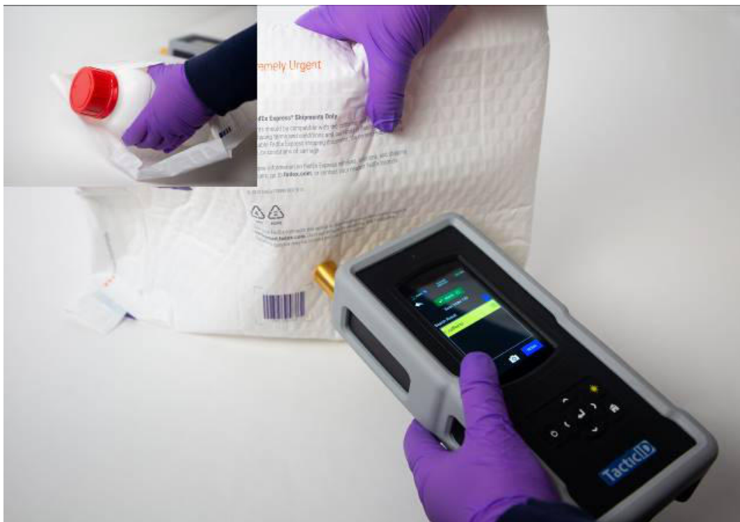
Figure 5. Misurazione della bottiglia di caffeina in HDPE bianca all'interno della confezione imbottita bianca
