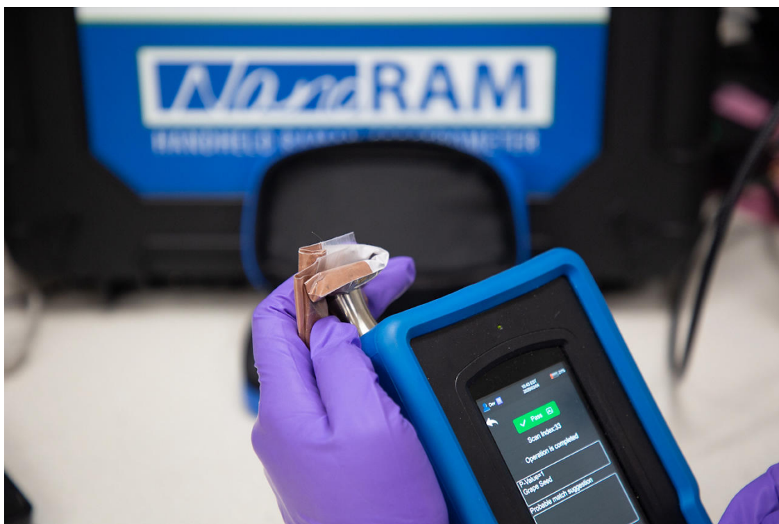
Figure 2. Analisi dell'estratto di semi d'uva con laser 1064 nm con adattatore point and shoot.
