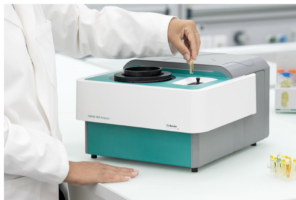
Figure 1. OMNIS NIR Analyzer e un campione sono stati riempiti in una fiala monouso.
