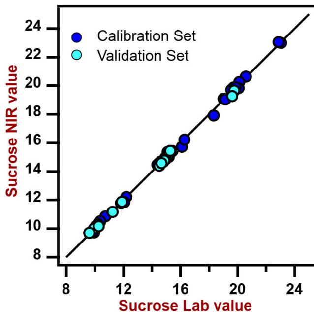
**Figure 5.** Diagramma di correlazione e le rispettive figure di merito per la previsione del contenuto di saccarosio in una miscela acquosa di zucchero utilizzando DS2500 Liquid Analyzer.
