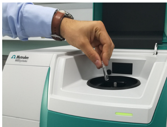
Figure 1. Analizzatore di liquidi DS2500 e un campione di fluido di scarico diesel riempito in una fiala monouso.
