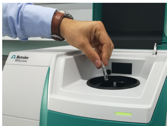
Figure 1. Analizzatore di liquidi DS2500 e un campione di olio di palma presente in una fiala monouso da 8 mm.
