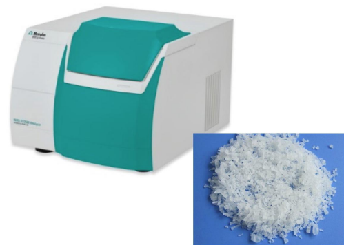
Figure 1. L'analizzatore solido DS2500 è stato utilizzato per raccogliere gli spettri del polimero PVA.
