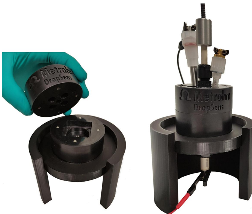
Figure 1. REFLECELL-C, la cella UV-Vis per elettrodi convenzionali. Vista interna (L) e cella completamente assemblata con WE, CE, RE e fibra ottica tenuta con pezzo di bloccaggio per un posizionamento ottimale (R).
