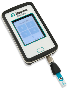
Figure 1. Lo strumento DROPSTATPLUS e CASTDIR utilizzati per collegare gli elettrodi serigrafati.
