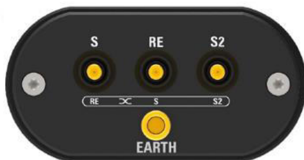
Figure 2. Qui è mostrata la scatola del buffer (parte del ponte di segnale puro) con le connessioni per la messa a terra, così come i cavi adattivi del senso (S), riferimento (RE) e secondo senso (S2).
