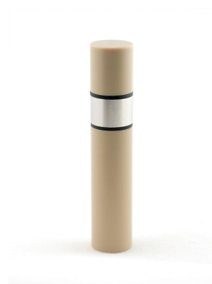
Figure 1. Elettrodo a cilindro rotante che mostra l'inserto metallico, gli O-ring in Viton (nero) e il supporto in PEEK.
