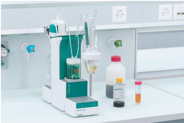
Figura 1. 859 Titrotherm con tiamo. Esempio di setup per la titolazione termometrica del ferro ferroso.
