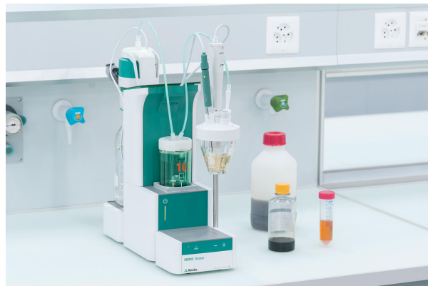
Figure 1. OMNIS Titrator Professional dotato di termosonda e agitatore a barra.
