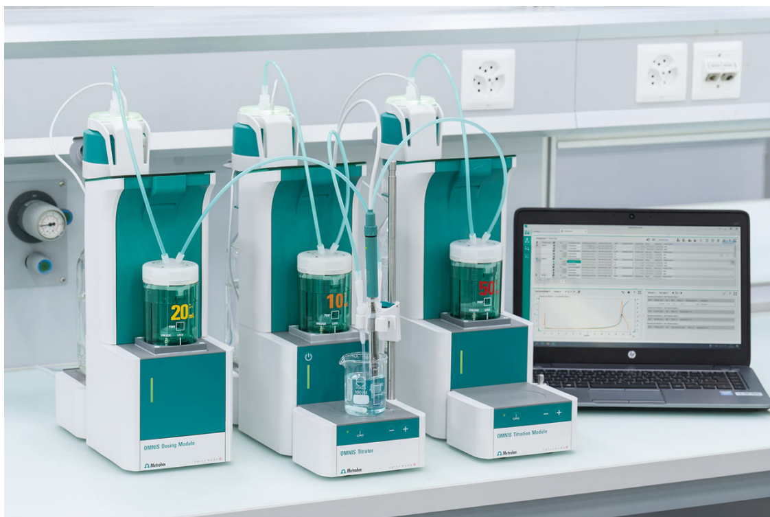
Figure 2. Titolatore OMNIS dotato di elettrodo dSolvotrode per la determinazione del contenuto di caffeina in campioni non acquosi.
