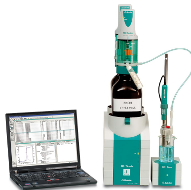
Figure 1. 905 Titrando con tiamo. Esempio di setup per la determinazione dell'acidità titolabile nei prodotti caseari.
