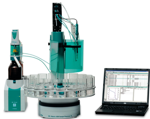
Figure 1. Sistema Titrando composto da un 815 Robotic USB Sample Processor XL in combinazione con un 907 Titrando.
