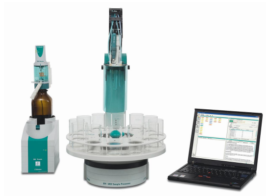
Figura 1. 814 Sample Processor e 905 Titrand dotati di un iAg-Titrode con rivestimento Ag 2 S controllato dal software tiamo.
