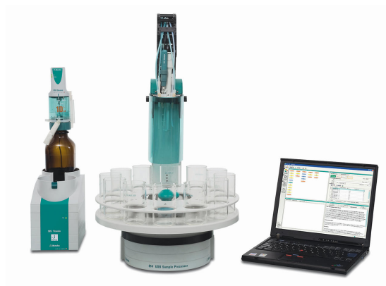
Figura 1. 814 Sample Processor e 905 Titrando dotati di un iAg-Titrode con rivestimento Ag 2 S controllato dal software tiamo.
