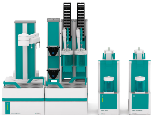
Figura 1. OMNIS Sample Robot S, OMNIS Dosing Module e OMNIS Advanced Titrator dotato di dProfitrode e dAg-Titrode per la determinazione del contenuto di cloruri.
