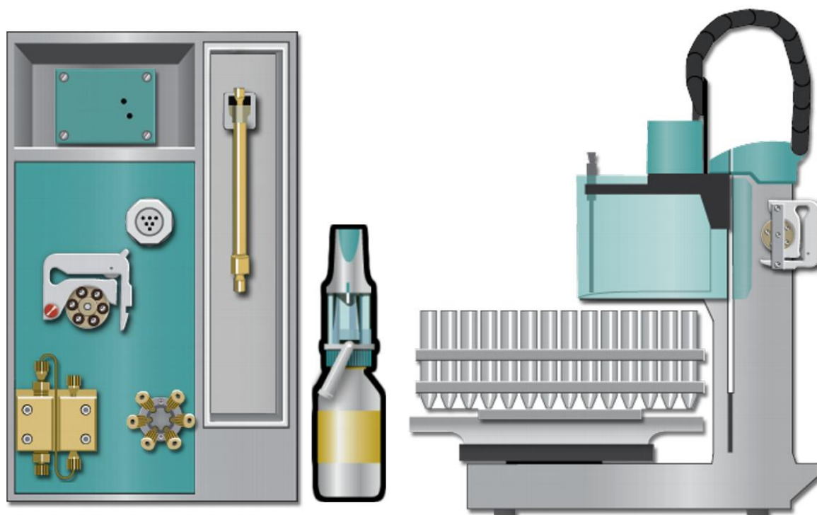
Figure 2. Strumentazione compatta per quantificare il carbonato in idrossido di sodio: Compact IC Flex con Dosino per MiPT e 858 Professional Sample Processor.
