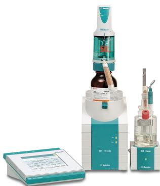
**851 Titrando con elettrodo generatore con diaframma**
