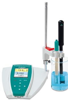
**Figure 1.** 914 pH/DO/Conduttometro dotato di O<sub>2</sub>-Lumitrode, cella di misura della conducibilità e iUnitrode (mancante nell'immagine) per la determinazione di DO, K (conducibilità) e pH in prodotti lattiero-caseari liquidi.
