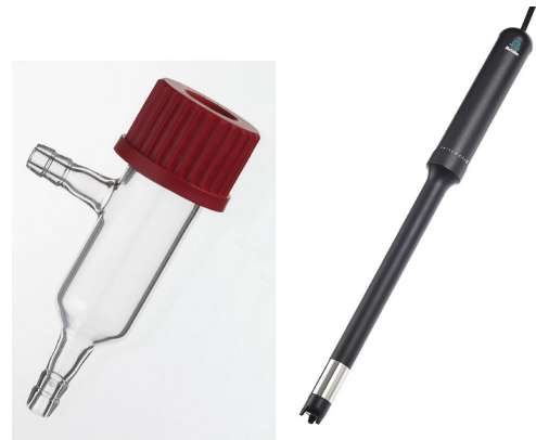
Figura 1. Cella a flusso passante usata (a sinistra) e O 2 -Lumitrode (a destra).
