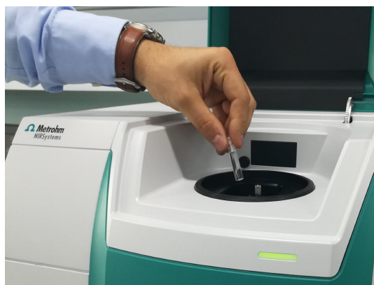
Figure 1. DS2500 Liquid Analyzer et un échantillon rempli dans un flacon jetable.
