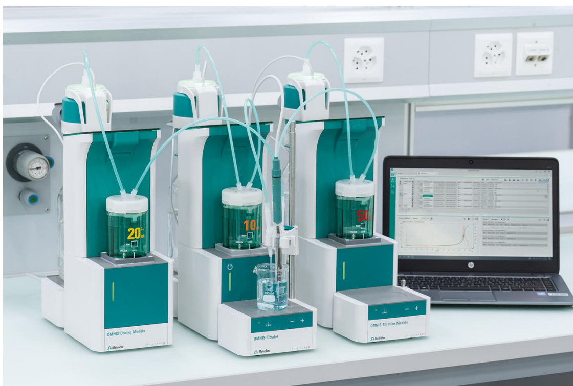
Figure 2. OMNIS Titrator équipé d'une électrode dSolvotrode pour la détermination de la teneur en caféine dans des échantillons non aqueux.
