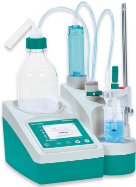
Figure 1. Titrateur Eco équipé d'une Titrode Ag.
