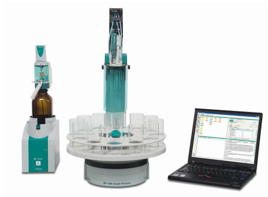
Figure 1. 814 Sample Processor et 905 Titrand équipé d'une iAg-Titrode avec revêtement Ag 2 S contrôlé par le logiciel tiamo.
