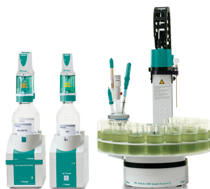
Figure 1. Exemple de système : 815 Robotic USB Sample Processor XL avec un récipient de titrage externe, 905 Titrand et 856 Conductivity Module équipé d'une iAquatrode plus, d'une iAg-Titrode et d'une cellule de mesure de la conductivité à 5 anneaux pour l'analyse de l'eau du robinet.
