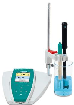
**914 pH/DO/Conductometer, modèle de laboratoire**
